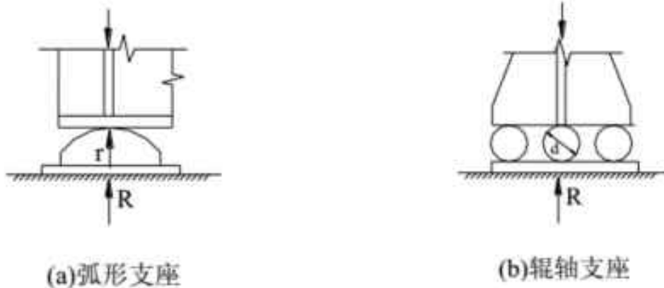
图 13.7.3 弧形支座与辊轴支座示意图
