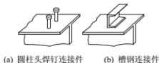
图 15.3.1 连接件的外形
