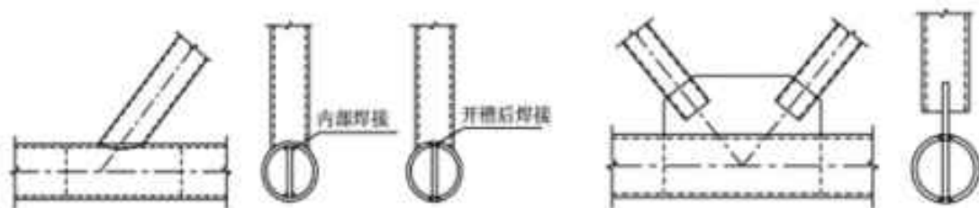
图 14.2.3-1 主管内纵向加劲的节点
