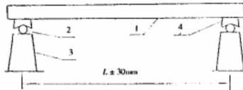
图 B.0.1 试验用支架
