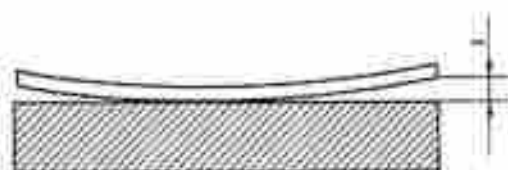
图2 连轧钢板不平度的测量
