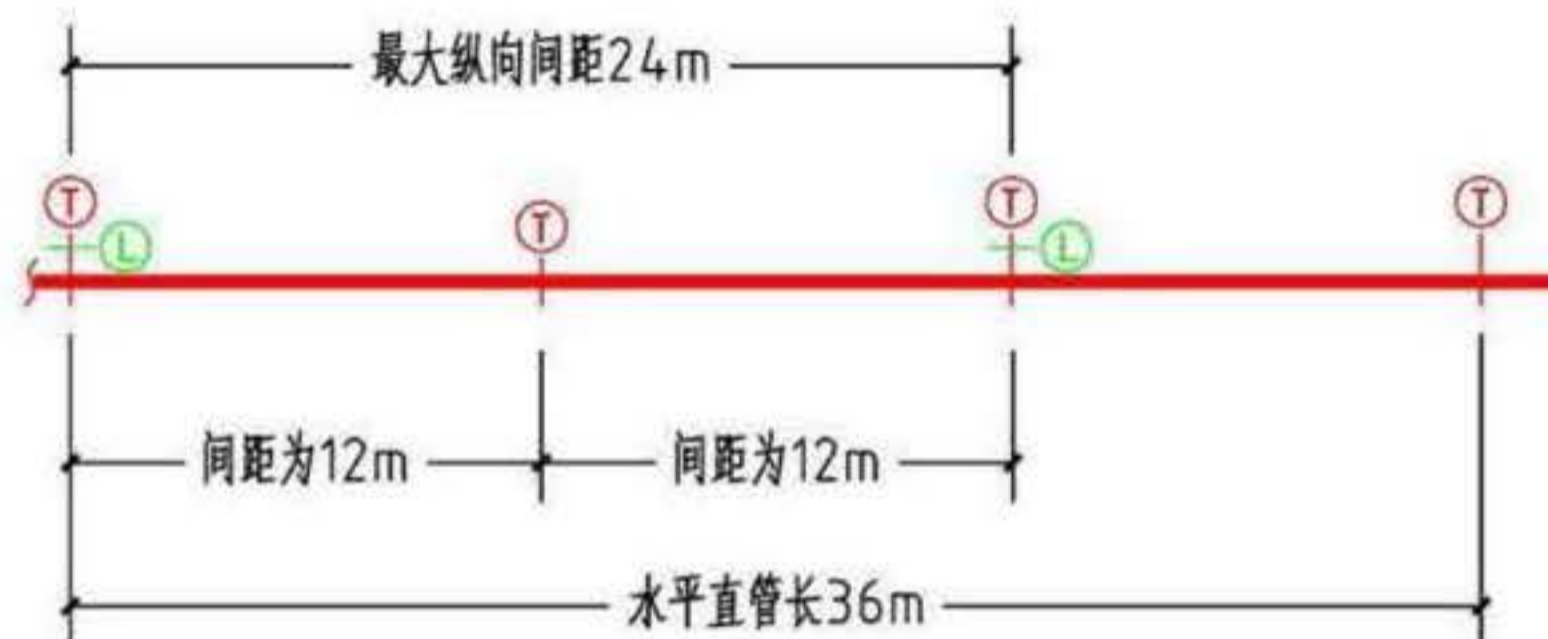
图2 水平直线段纵向抗震支吊架设置示意
