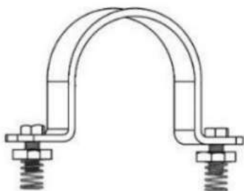
图 C.1 Ω管夹的结构型式示意图
